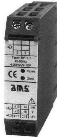
Die Messumformer MF-1.1 dienen zur Umformung und Trennung einer Frequenz in ein eingprägtes Gleichstrom- und Gleichspannungssignal. Die zu messende Frequenz gelangt über einen internen Spannungswandler, der zur galvanischen Trennung dient, zu einem Filter und anschließend zu einem Mikrocontroller, der die Auswertung übernimmt. Die hier gewonnene Gleichspannung wird in einen eingprägten Gleichstrom und eine eingprägte Gleichspannung umgeformt.
