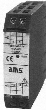
Die Messumformer MA-1.1s dienen zur Umformung eines sinusförmigen Wechselstroms in ein eingprägtes Gleichstrom- und/oder Gleichspannungssignal. Der zu messende Wechselstrom gelangt über einen internen Stromwandler, der zur galvanischen Trennung dient, zur nachfolgenden Gleichrichterschaltung. Die gewonnene Gleichspannung wird verstärkt und in einen eingprägten Gleichstrom oder eine eingprägte Gleichspannung umgeformt. Der Ausgang ist leerlauf- und kurzschlussfest.
